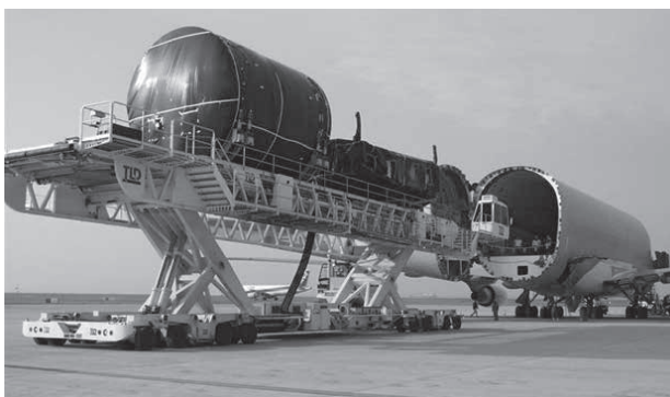
写真2 初号機出荷（ドリームリフターへの積み込み）
